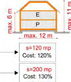
Schema reflectă modul în care mansardarea podurilor (pentru clădiri cu gabarit mic și mediu) reprezintă un câștig din punct de vedere al costurilor față de construirea unui nou etaj. Construirea unei clădiri înalte pune serioase probleme de încadrare în specificul local. De asemenea, prin realizarea unui atic mai înalt în mansardă se obține o suprafață aproape egală cu cea de la parter.
