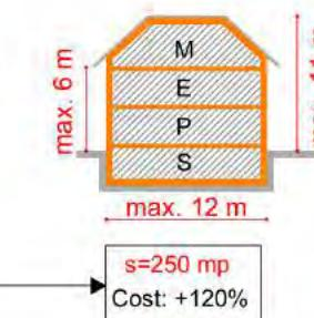
Schema reflectă modul în care construirea unui nivel semiîngropat poate aduce spor de suprafață în cazul clădirilor cu gabarit mediu.
